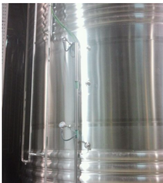
Fig. 2: Vista de los puntos de inserción en depósito del sistema de medición de heterogeneidad aplicable a cualquier proceso enológico.
